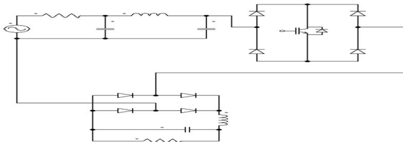
**Figure 2: Single Phase Buck Rectifier**
